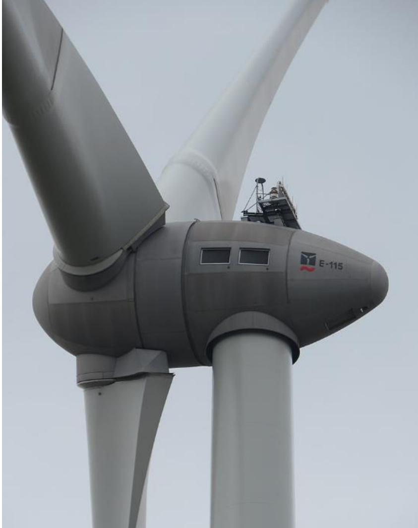
Getriebelose, direkt angetriebene WEA: Z.B. Enercon, Aurich/Hamburg. Teurer in der Anschaffung. Günstiger in der Wartung.
